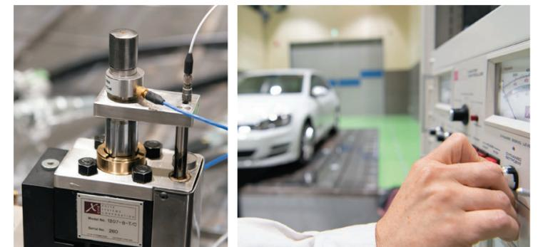
Lab.5には、油圧加振システムが2セット設置されています。汎用性の高い小型加振ヘッドとオリジナルで作製する治具の組合せにより、多様な実験が可能です。
